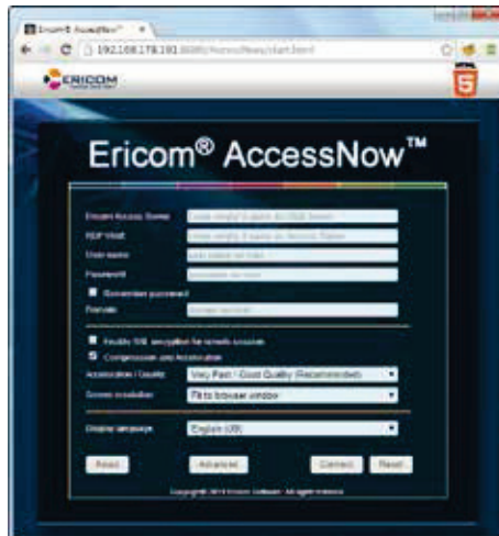
Bild 2. Über diese Eingabemaske können Benutzer auf ihrem Client angeben, wie sie die Verbindung zum Accessnow-Server herstellen wollen.
